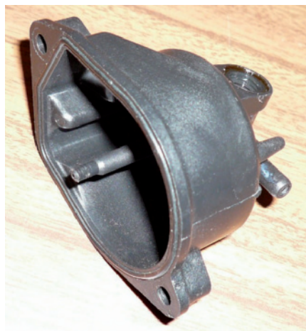
Figura 1 - Il pezzo: una vaschetta carburatore per motociclo. In resina PTB Valox 420 caricato con 30% vetro esso è riprodotto con ottimi risultati mediante stampaggio a iniezione con attrezzo a canali isolati
