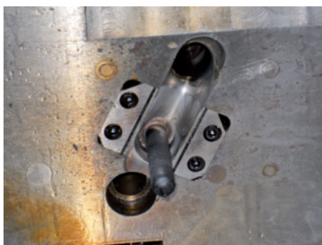
Figura 8 - Dettaglio del punto d'iniezione: si notano il "torpedo" e il tassello riscaldante previsto in via eccezionale per mantenere fluida la resina anche nella critica zona del punto d'iniezione
