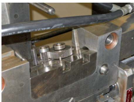
Figura 9 - Il movimento lineare del cilindro oleodinamico di svitamento maschio filettato viene trasformato in movimento di rotazione tramite questi ingranaggi e una cremagliera
